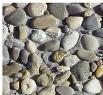
**Le béton lavé est sensible aux acides. Bien mouiller les joints avant d'utiliser des nettoyeurs acides.
