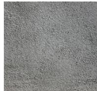
Zementmörtel besteht aus Portlandzement und Sand.
