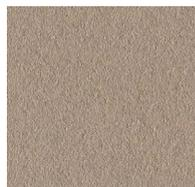
Le lino-liège est un produit 100 % naturel composé d'huile de lin, de granules de liège et de bois, de résines, de colorants et de calcaire sur une base en jute.
