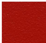
Les revêtements de sol à base de xylolithe sont fabriqués à partir de magnésie, de poudre de quartz, de fibres de bois, de matières de remplissage et de couleurs oxydes.
