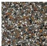
Les pierres artificielles sont des mélanges d'éclats de pierres de couleur coulés dans du ciment ou de la résine.
