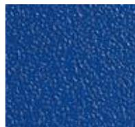
PVC ist ein synthetischer Belag aus Polyvinylchlorid (PVC), Weichmachern, Füllstoffen und Farbpigmenten.
